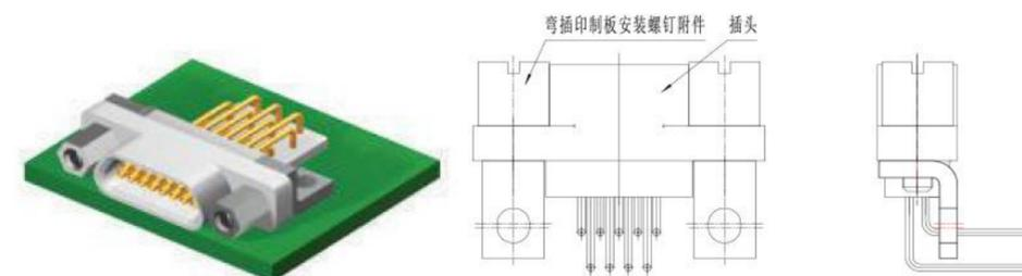
说明: Ln6. 150. 025安装螺钉组件用于9、15、21、25、31、37芯产品的安装用。
