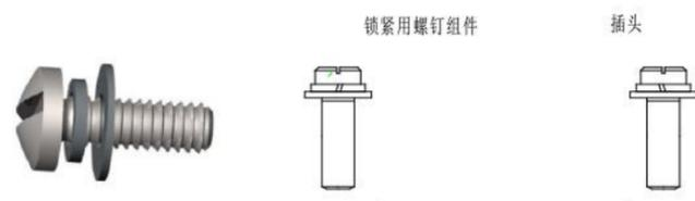
说明: 标准螺钉组件用于连接器的自由端, 将插头与插座对接在一起后, 把组件再单独拧上去, 实现插头与插座的锁紧。缺点是在插头与插座分离时, 组件易丢失。
