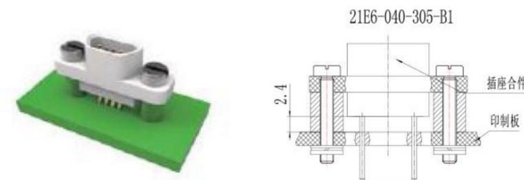
说明: Ln6. 480. 028安装螺钉组件用于J30-XXTJN/ZKN、J30-XXTJN1/ZKN1、J30-XXTJN-J/ZKN-J产品的安装用。
