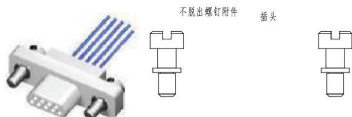
说明: 不脱出螺钉组件用于连接器的自由端, 此种组件在锁紧的同时, 实现插头与插座对接与锁紧。缺点是在插头与插座对接与组件的锁紧必须同时进行。
